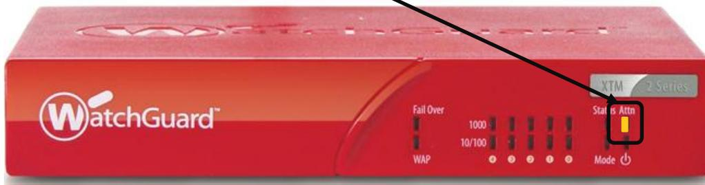
起動途中に点滅したりしますが、Reset ボタンはずっと押し続けます。
