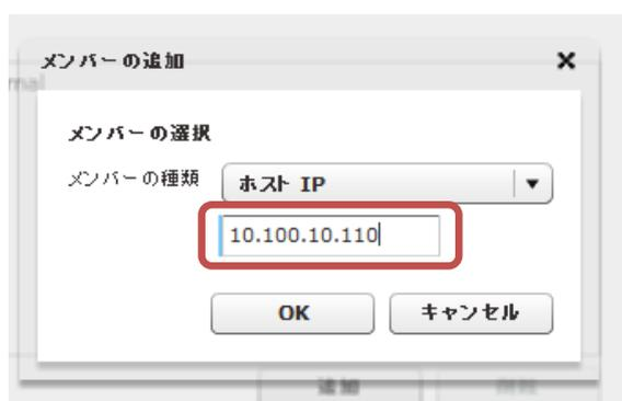
メンバーの追加画面では種類の選択ではホスト IP、値は Web サーバーの IP アドレスを入力して OK。ポリシーの新規作成画面に戻ると、以下のように送信先が設定されています。
