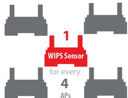
ます。これは、ウォッチガードが推奨する導入モデルであり、専用の WIPS センサ機が常に空間を防御し、WIPS/AP モード機によって生じる時間枠を攻撃者が使用しないようにできるため、最も安全な無線環境が実現します。
